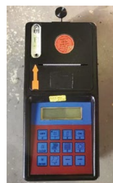
BILD 14: Verwendetes Verzögerungsmessgerät vom Hersteller MAHA, Typ VZM 100 FIGURE 14: Used delay measuring instrument from the manufacturer MAHA, type VZM 100
