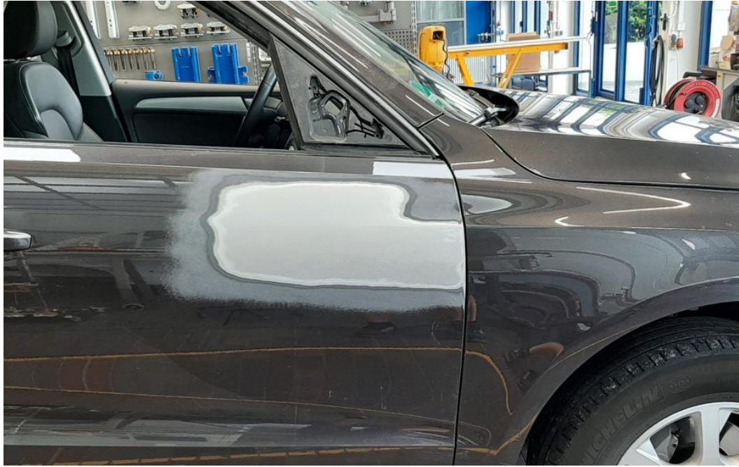
Abbildung 9: Definierter Übergabezustand wurde ohne Verwendung von Karosseriefüllmasse erreicht.
