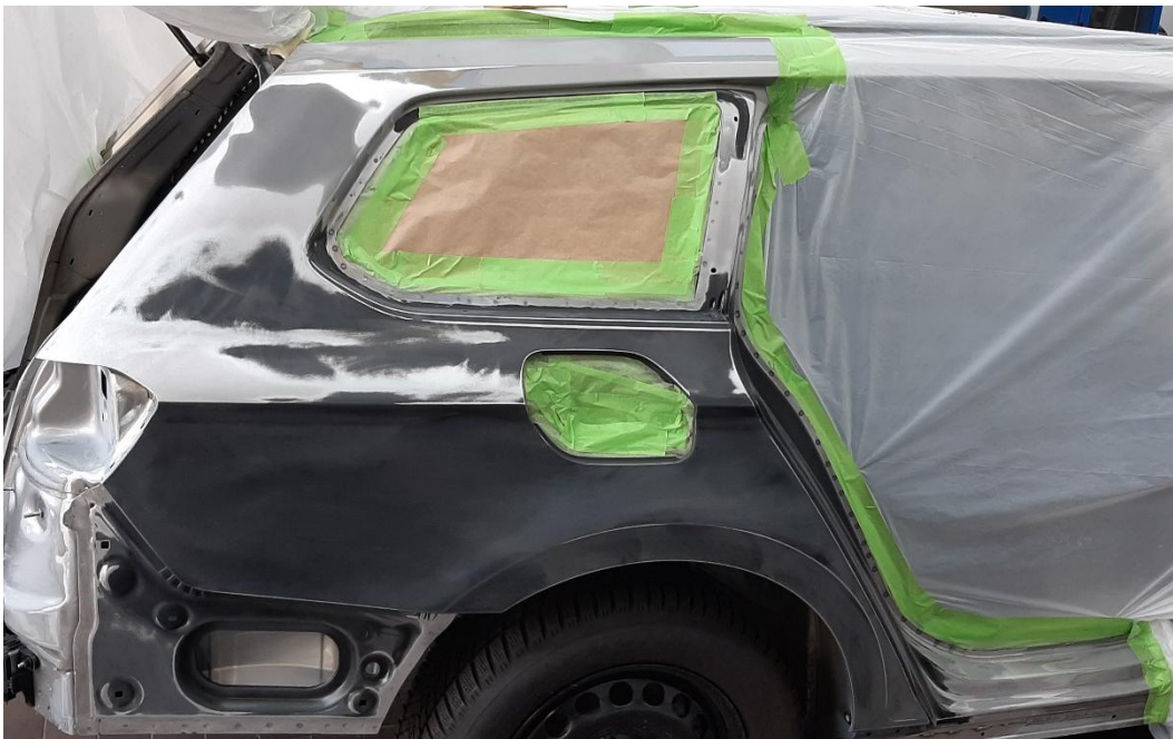
Abbildung 16: Neue Seitenwand rechts (Einschweißteil) an VW Passat (B8; BJ 2015) – Übergabezustand durch Einsatz von 2K-Epoxidharz-Karosseriefüllmasse erreicht.
