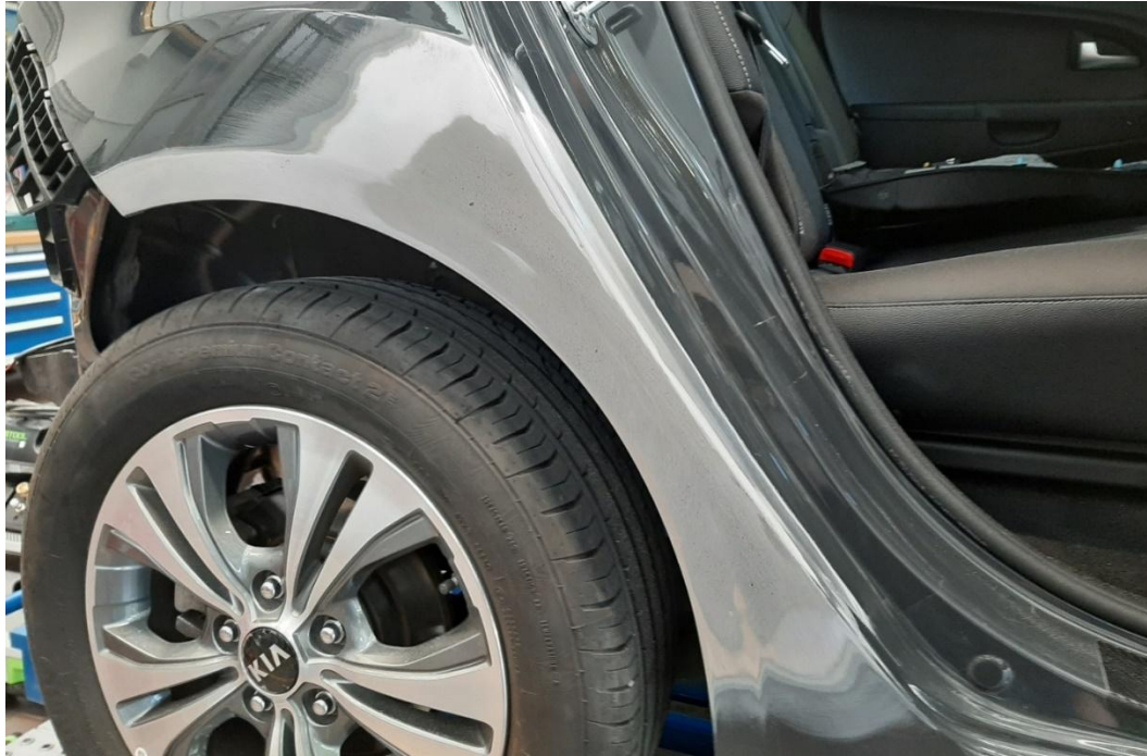
Abbildung 7: Definierter Übergabezustand wurde nach Schleifen der 2K-Epoxidharz-Karosseriefüllmasse erreicht.
