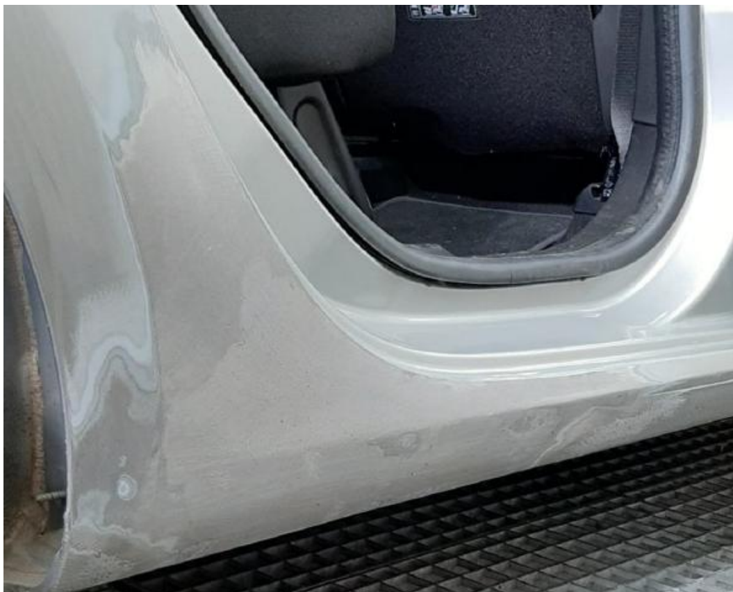
Abbildung 4: Definierter Übergabezustand wurde nach Schleifen der 2K-Epoxydharz-Karosseriefüllmasse erreicht.
