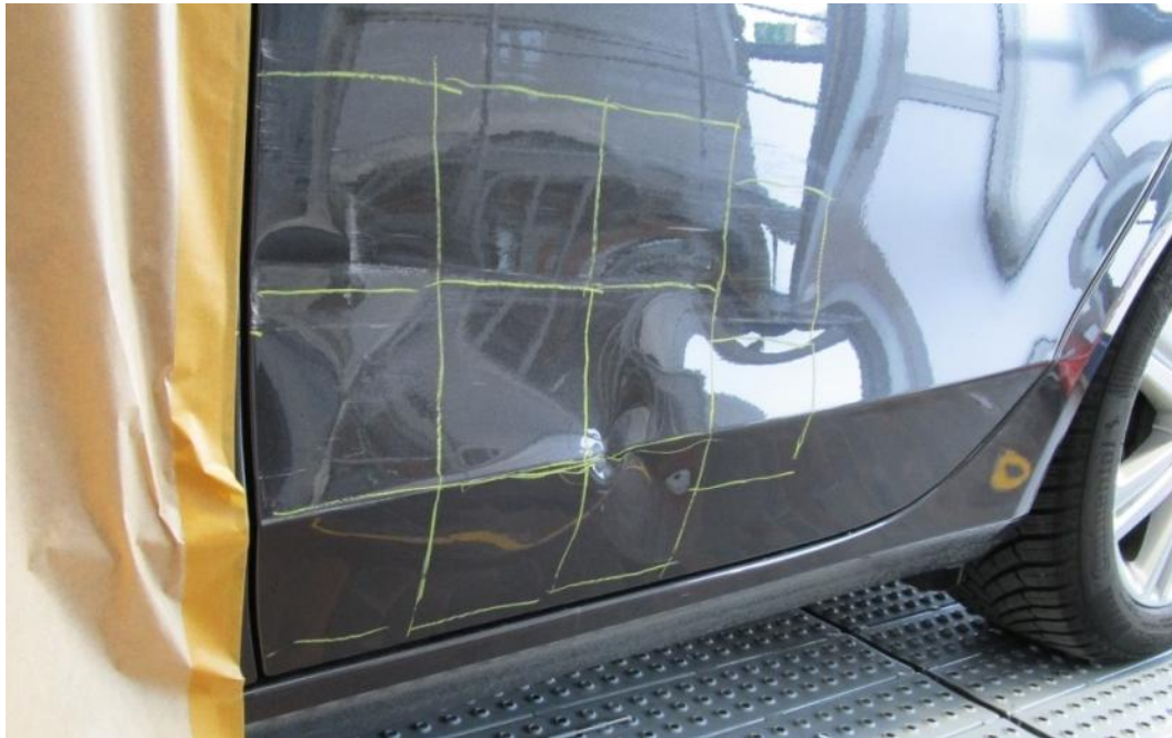
Abbildung 10: Ausmaß der Beschädigung vor Instandsetzungsbeginn – Bsp. 4.
