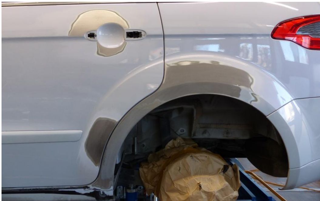
Abbildung 14: Ford S-Max (WA6; BJ 2012) mit Instandsetzung von Tür hinten links (ohne Karosseriefüllmasse) und linker Seitenwand (mit Einsatz von 2K-Epoxidharz-Karosseriefüllmasse).
