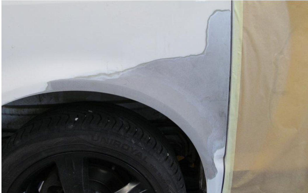
Abbildung 13: Volkswagen T5 (BJ 2013) mit instandgesetzter Seitenwand rechts – Übergabezustand unter Verwendung von 2K-Epoxidharz-Karosseriefüllmasse erreicht.
