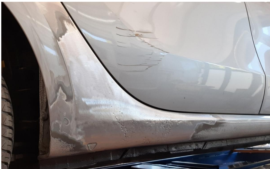
Abbildung 2: Schweller / Kniestück nach erfolgter Blech-Instandsetzung und vor Auftrag von 2K-Epoxidharz-Karosseriefüllmasse.
