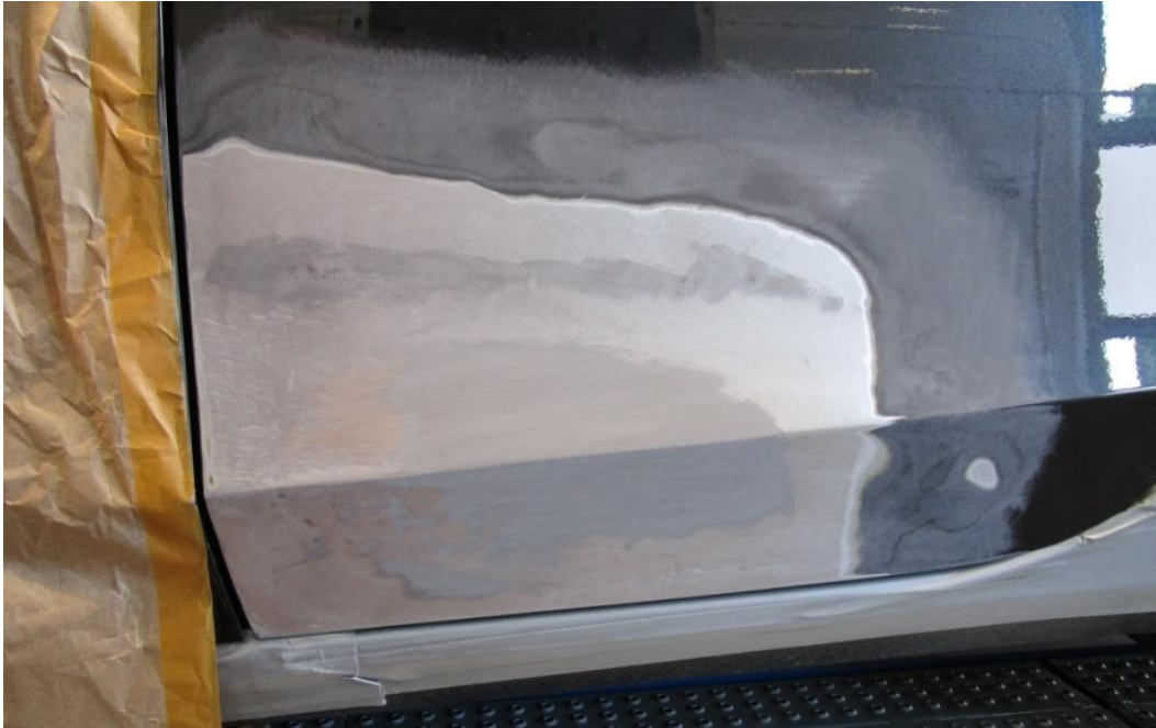
Abbildung 11: Definierter Übergabezustand wurde mit Einsatz von 2K-Epoxidharz-Karosseriefüllmasse erreicht.
