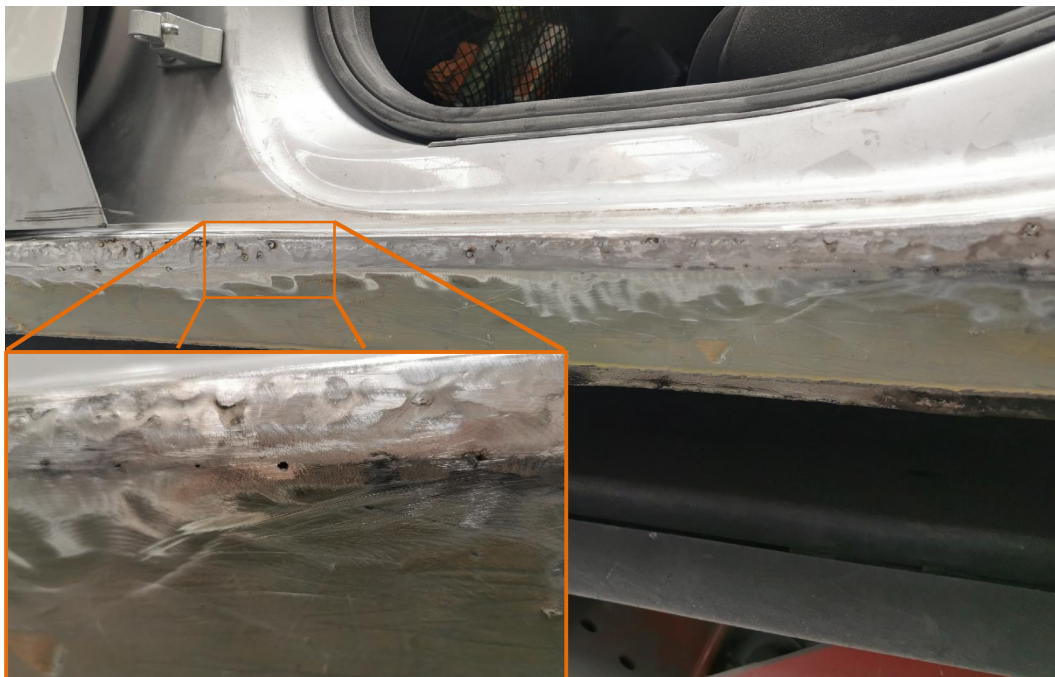
Abbildung 18: Nicht erreichter Übergabezustand auf Grund von und nicht zugeschweißten Löchern im Blech, fehlende finale Blechbearbeitung bzw. Auftrag von Karosseriefüllmasse, hoher Rautiefe bedingt durch fehlenden Endschliff und fehlendem gleichmäßigem Übergangsbereich zum bestehenden Lack.
