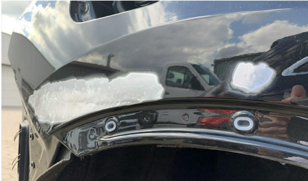
Abbildung 17: Übergabezustand nicht erreicht, da Instandsetzungsarbeit vergleichsweise grob und unpräzise mit tiefen Kratzern in Blech und angrenzendem Lack sowie fehlendem gleichmäßigem Übergangsbereich zum bestehenden Lack.
