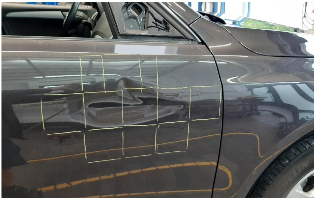
Abbildung 8: Ausmaß der Beschädigung vor Instandsetzungsbeginn – Bsp. 3.
