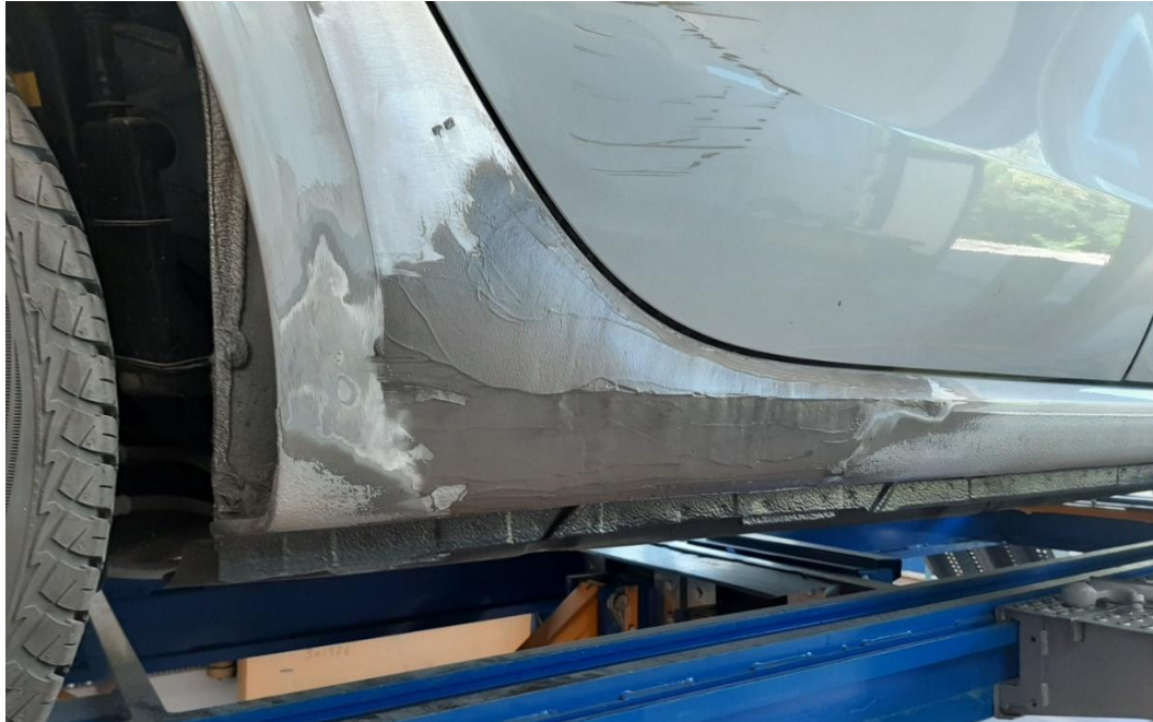
Abbildung 3: Schweller / Kniestück nach Auftrag von 2K-Epoxydharz-Karosseriefüllmasse.
