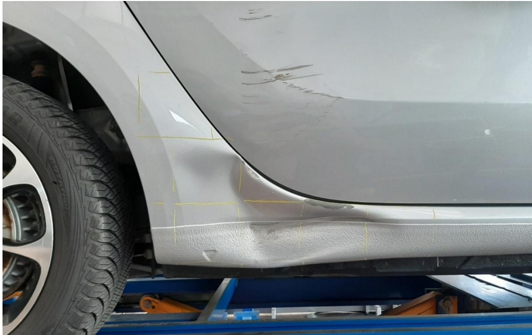
Abbildung 1: Ausmaß der Beschädigung vor Instandsetzungsbeginn – Bsp. 1.
