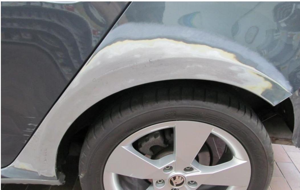
Abbildung 12: Skoda Octavia (5E; BJ 2015) mit instandgesetzter Seitenwand links – Übergabezustand durch reine Karosserie-Instandsetzung ohne Einsatz von 2K-Epoxidharz-Karosseriefüllmasse erreicht.
