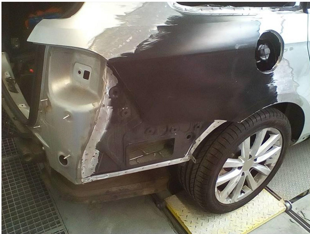
Abbildung 20: Nicht erreichter Übergabezustand, im Wesentlichen verursacht durch fehlende gleichmäßige Übergangsbereiche von Neuteil zu bestehender Karosserie und fehlendem Endschliff.
