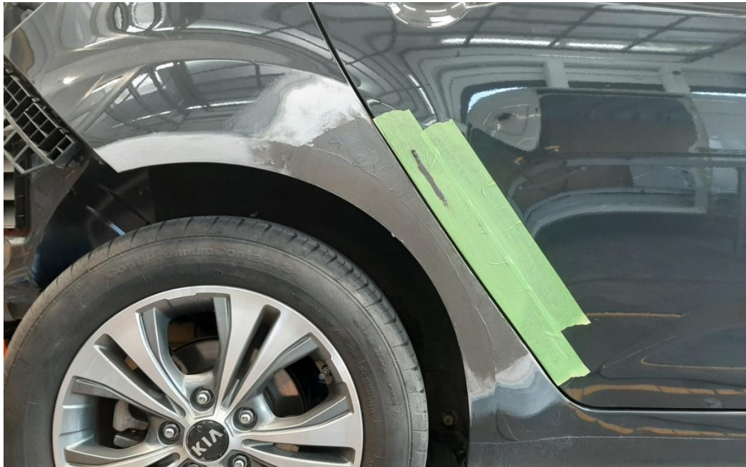
Abbildung 6: Auftrag von 2K-Epoxidharz-Karosseriefüllmasse nach erfolgter Blech-Instandsetzung.
