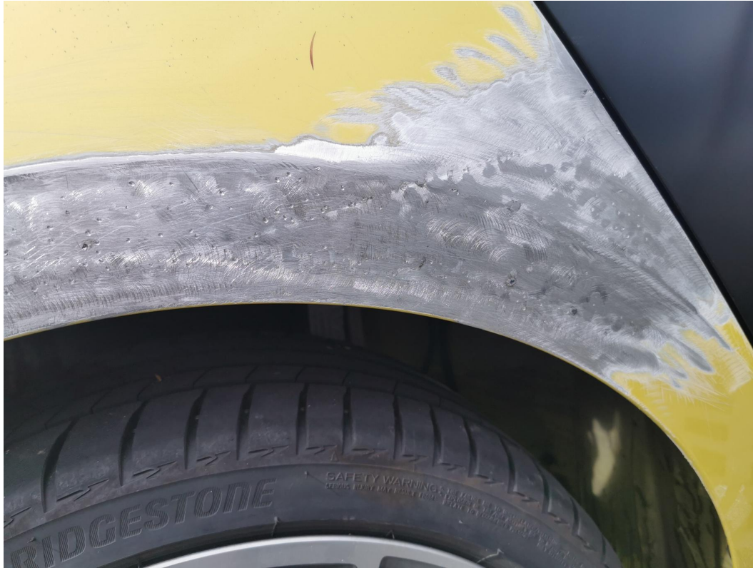
Abbildung 19: Nicht erreichter Übergabezustand auf Grund von hoher Rautiefe und fehlendem gleichmäßigen Übergangsbereich durch nicht erfolgten Endschliff.
