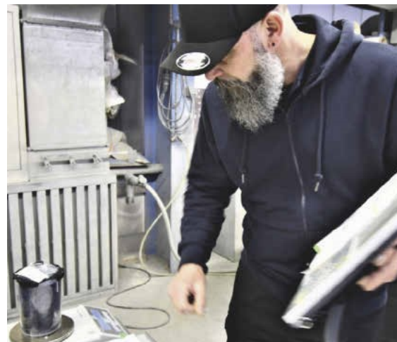
Lackmaterialien werden von Bruno Rauch (AZT) vor dem Gang in die Kabine abgewogen. Restmengen werden ebenso akribisch erfasst.
