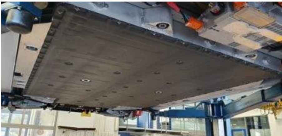
Bild 1: Beispiel für austauschbaren Batterieschutz, wie z.B. bei VW und Audi verbaut
