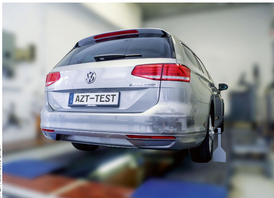
Bild 1 > VW Passat Variant (B8 – BJ 2025) mit teiltransparenter Darstellung des Bereichs des beifahrerseitigen SRR-Heckradarsensors.
