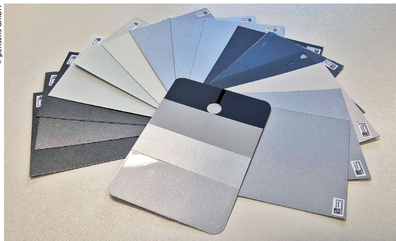
Bild 3 > Abschnittsweise lackiertes Farbmusterblech sowie diverse lackierte PET-Folien für die Schichtdicken- und Radarbeeinflussungsmessung.
