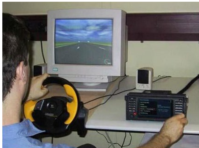
Bild 18: Der Lane Change Test im Laboreinsatz: Die Leistung bei Spurwechselaufgaben und gleichzeitiger Nebentätigkeit (Bedienung von Geräten im Fahrzeug), (Bild: Daimler AG, Testinstrumentarium: Mattes, Daimler AG)
