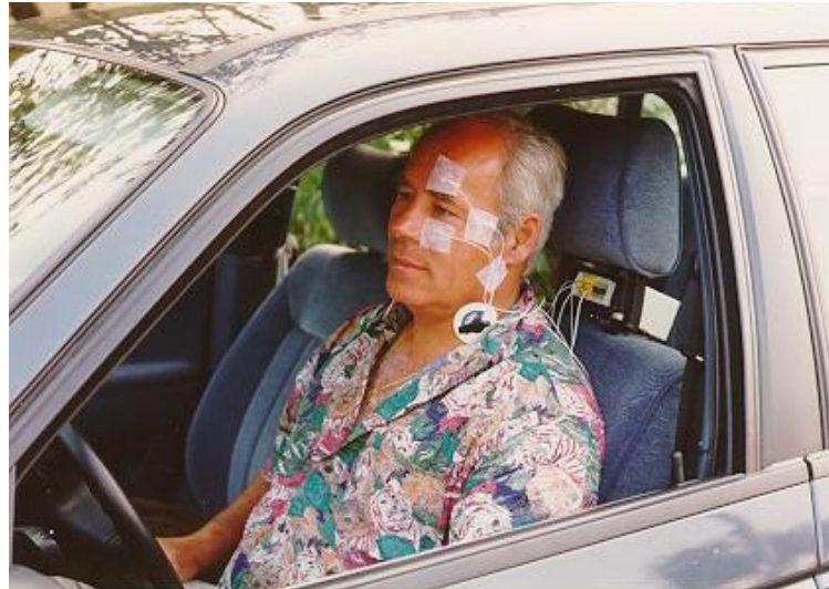
Bild 16b: Work-Load, Wachheit, Aufmerksamkeit – nicht leicht zu trennende Zustände. Messung der Augenmuskellaktivitäten beim Fahren als eine der verschiedenen möglichen Größen der Fahrer-Beanspruchung (Bild: FG ASS e.V.)
