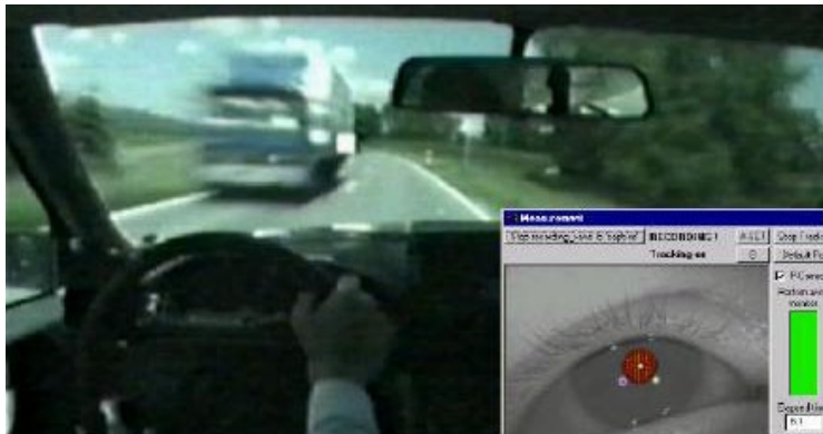
Bild 19: Antizipation. Hazarddetection. Der Fahrer schaut bereits, was hinter dem Lkw folgen könnte: Blickbewegungsmessung mit Eye-Tracking-Systemen, ETS (Bild: Scherbarth, zit. nach Schneider et al., 2002)
