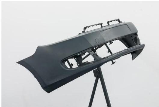
**Hinweis:** Wenn vom Lackhersteller ein anderer Untergrundfarbton empfohlen und deswegen ein 2K-Kunststoffgrundfüller in entsprechender Graustufe im sog. „Nass-in-Nass“-Verfahren eingesetzt werden muss, entspricht dies nicht mehr der Lackstufe K1R, sondern der Lackstufe K1N.
